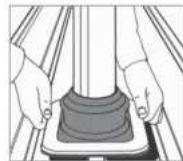
2. Illessze és jelölje a Dektite-ot a profilmezemen.
