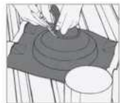
1. Illessze a Dektite-ot a csőhöz.
