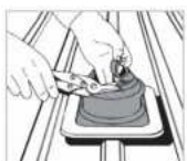
1. Illessze a Dektite-t a csőhöz.
