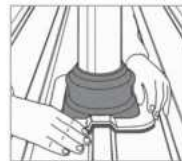
3. A Dektite illessze rá a tetőprofilra.
