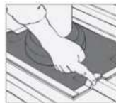
2. Illessze és jelölje a Dektite-ot a profilmezemen.
