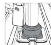
5. Rögzítse a Dektite-t önfúró csavarral vagy Bulb-tite szegéccsel
