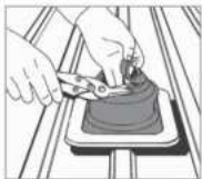
1. Illessze a Dektite-ot a csőhöz.
