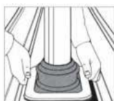
2. Illessze és jelölje a Dektite-t a profilmezén.
