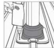
4. Rögzítse a Dektite-ot önfúró csavarokkal vagy Bulb-tite szegecsekkel.
