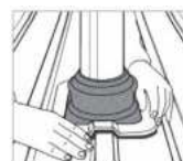
4. A Dektite-t pontosan formálja rá a profilmezére.
