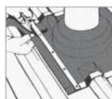
7. Az átlapolandó részek tömítéséhez használja a mellékelt acélszalagokat. Ahol szükséges, vágja le a felesleges széleket.
