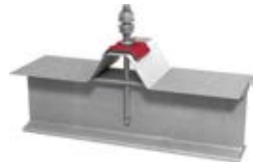
JT3-SB-3-8,0xL mit Dichtscheibe E16 + ORKAN-Kalotte für Trapezprofile
