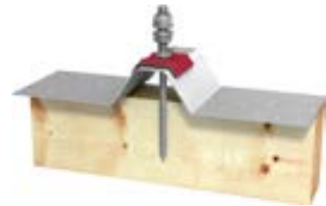
JA3-SB-8,0xL mit Dichtscheibe E16 + ORKAN-Kalotte für Trapezprofile
