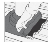
5. Vigye fel a tömítőanyagot és a Dektite-ot formázza a tetőprofilra.
