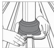
3. A Dektite illesse rá a tetőprofilra.
