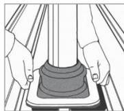
2. Illesse és jelölje a Dektite-ot a profilmezén.
