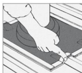
2. Illesse és jelölje a Dektite-ot a profilmezén.
